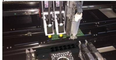
Inoplacer PRO 22D: Doppelbestückkopf, Dispenser und Werkzeugwechsler
