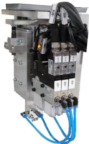
kompletter Greifer mit Vakuumerzeugern und Z-Hub
