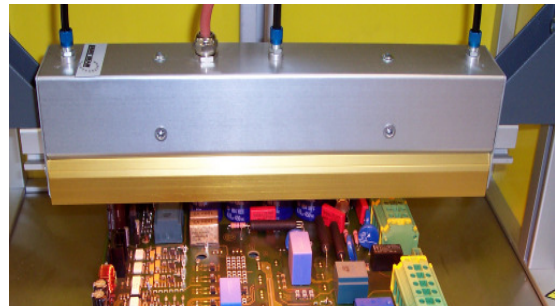
Vorwärmen und Aktivieren von Flussmittel
