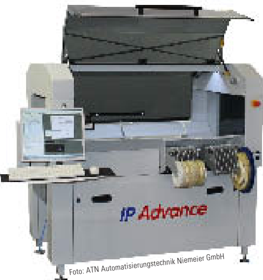
Der neue Inoplacer Advance bietet neben höherer Feederkapazität unter anderem auch optimierte Bestückköpfe.
