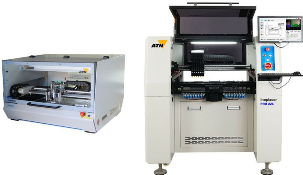
Inoplacer-Bestückautomaten sind für den Inline-Betrieb oder als Tischgerät erhältlich. (Bild: ATN Produktionstechnik Niemeier)
