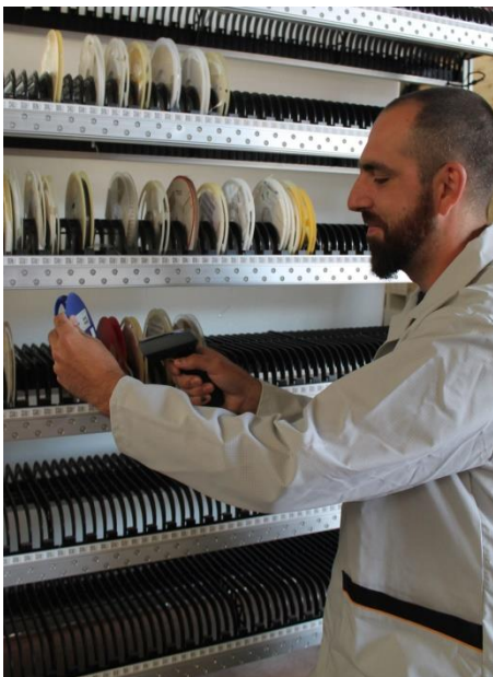
Das Ein- und Auslagern erfolgt über die Carrier-UID, die mit einem Scanner oder einem PDA (Personal Digital Assistant) gelesen werden kann.
