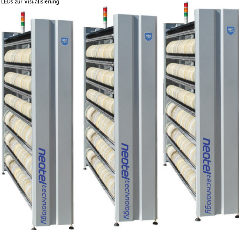
PickToLight-Regal des Kooperationspartners Neotel mit Datenbank und LEDs zur Visualisierung
