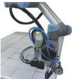
R-BUS: Lötstation mit Sechs-Achs-Roboter
