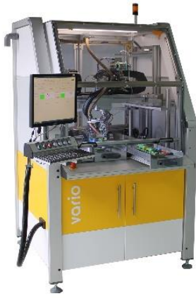
Abbildungen 4 ATN-Maschinenplattformen zum Roboterlöten
