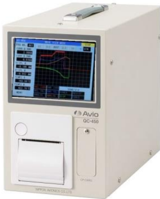
Datenlogger, -monitor und -auswerteeinheit Q450 und Screenshot
